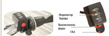
Индикатор заряда батареи с лапкой ГАЗА и выключателем светодиодных фонарей, служит для управления скоростью электровелосипеда.
