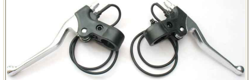
ручки тормозов с датчиками срабатывания датчики срабатывания дают сигнал контроллеру на отключен электродвигателя мотор-колеса
