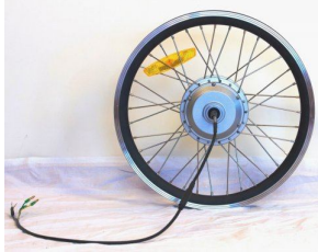
Мотор-колесо - электродвигатель установленный на оси колеса велосипеда.
