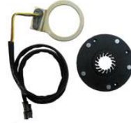
Датчик помощи (PAS) - служит для включения двигателя при вращении педалей. На пластиковой шайбе установлены 5 магнитов, а на металлической шайбе закреплён датчик Холла.
