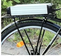
Батарея - необходима для питания электродвигателя. Внимание!: набор поставляется без батареи. Рекомендуем устанавливать литиевые аккумуляторные батареи ёмкостью не менее 10 А/час.
